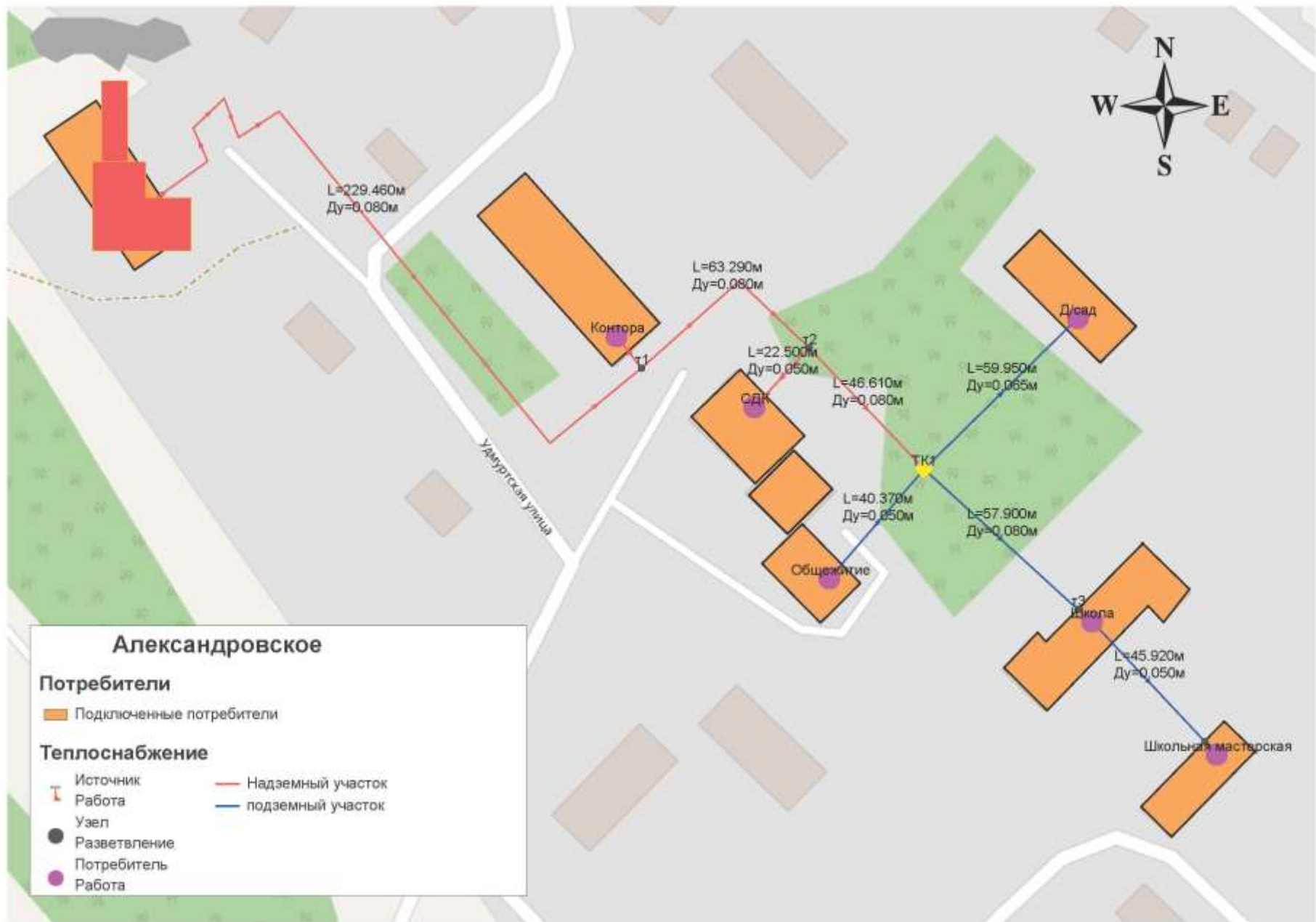
Рисунок 1. Принципиальная схема места расположения источника тепловой энергии – котельная № 7 с Александрово
